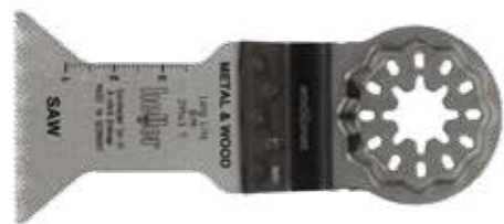
Sierra para metal y madera BIM, 50 x 44 mm Dentado universal ondulado. Chapa de acero, aluminio, Cobre, madera, yeso, plástico. Alta velocidad. n.º art.: 29543 7 & 29544 4
