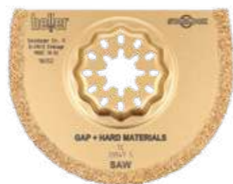
Sierra para material duro TC, 75 x 2,2 mm Para separar juntas de baldosas y ranuras de revoque y hormigón celular. Segmentada, ideal para esquinas y bordes. n.º art.: 29547 5
